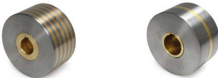
Hafträder mit Feinpol-Teilung, aus NdFeB, Bohrung mit Passungstoleranz H7
