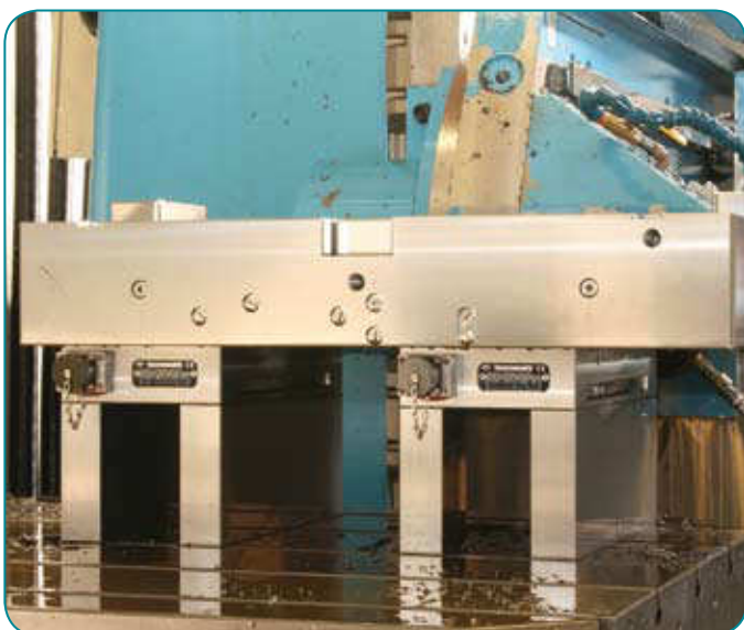
2 x QX HD 50 auf Säulen zum Tieflochbohren
