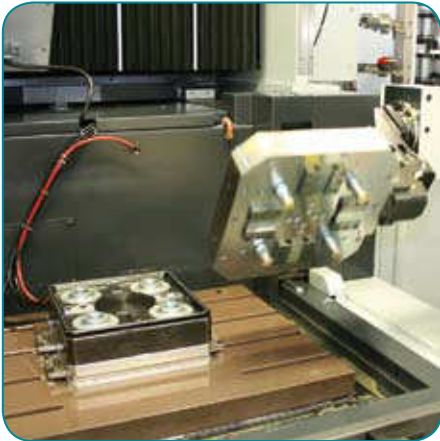
Bestückungsvorgang in einer Erodiermaschine mit Palettier-Magnetspannplatten-System Erowa
