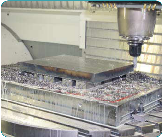
QX HD 70 mit Polverlängerungen für die Bearbeitung von Brennschnitten
